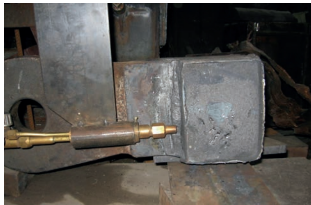
Рис. 3. Газокислородная резка выводного кармана
