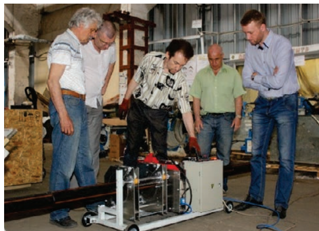
Промышленные испытания инновационной установки для сварки полимерных труб на производстве ООО «ТД «Евротрубпласт» (2017 г.)
