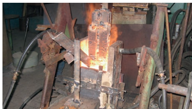
Рис. 1. Электрошлаковая наплавка молотка дробилки угольных мельниц
