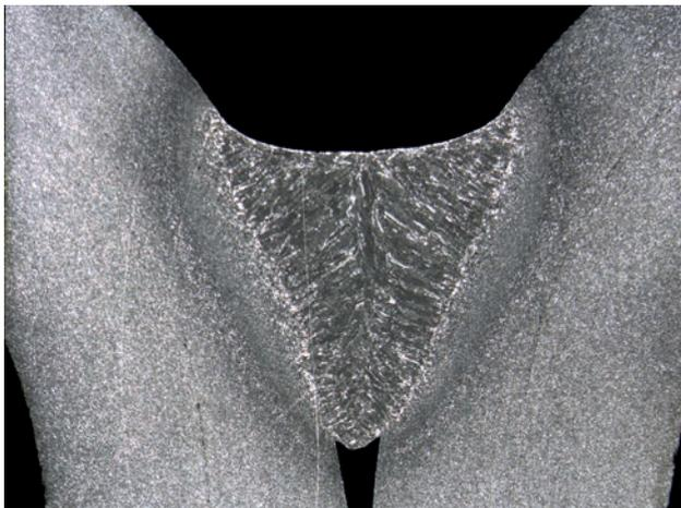
Рис. 5. Характеристика PCS имеет сфокусированную дугу, которая гарантирует глубокое проникновение. Она прекрасно подходит для небольших зазоров, угловых швов и корневых проходов
