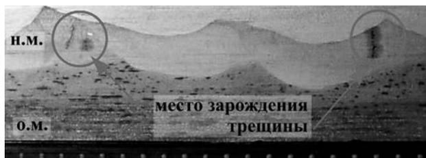
Рис. 8. Внешний вид боковой поверхности образца с участками, где зародились усталостные трещины: о. м. – основной металл, н. м. – наплавленный металл
