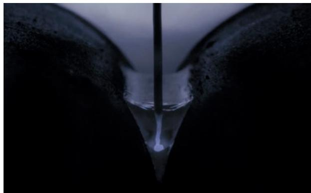
Рис. 4. Характеристика PCS (Pulse Controlled Spray Arc) позволяет выполнить плавный переход от импульсной к струйной дуге, чтобы создавать меньше сварочных брызг
