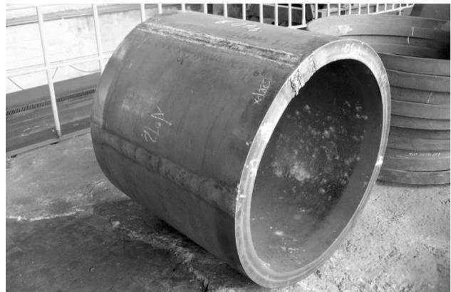
Рис. 5. Внешний вид корпуса тягового двигателя после ЭШС
