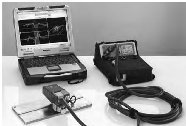
Рис. 6. Общий вид системы ACFM фирмы TSC Amigo
