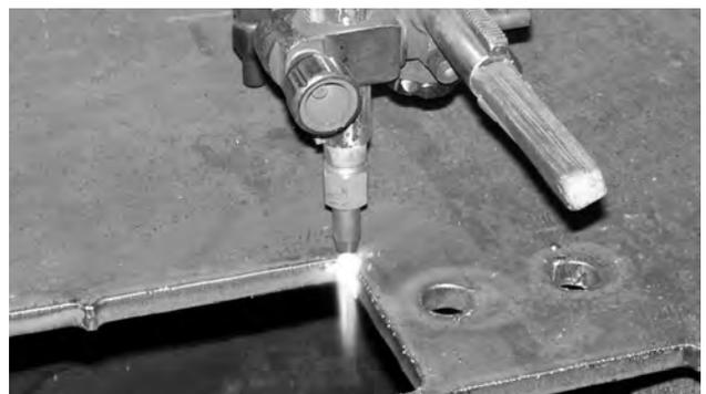
Рис. 12. Вырезка деталей из листа толщиной 16 мм
