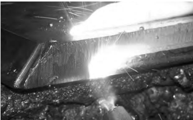
Рис. 16. Стенд для снятия фасок под сварку. Резка производится снизу - вверх под углом 60° к горизонтали. Процесс резки рину, что говорит о малых размерах участка ЗТВ. Различные эпизоды синхронной резки листа ре-
