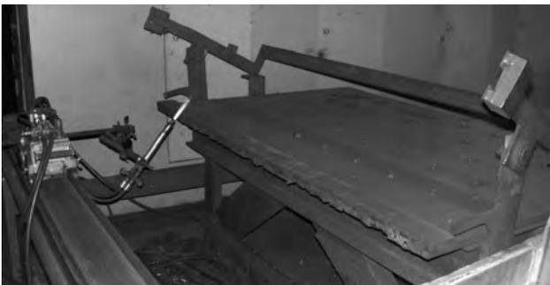
Рис. 15. Стенд для снятия фасок под сварку. Резка производится снизу - вверх под углом 60° к горизонтали. Факел резака РГКМ-1-SR
