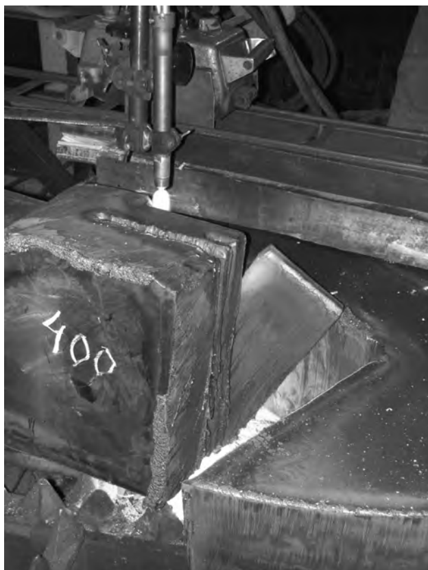
Рис. 3. Отработка режимов резки. Процесс резки и поверхность реза заготовки толщиной 400 мм
