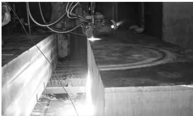
Рис. 17. Выход кислородной струи из заготовки толщиной 450 мм по окончании фигурной резки
