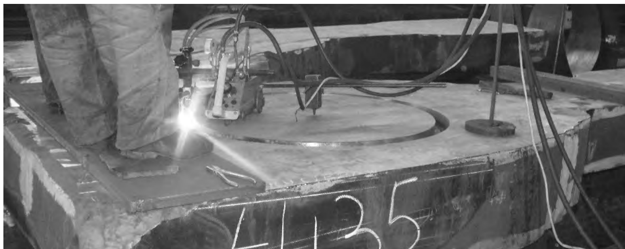
Рис. 20. Вырезка отверстия на заготовке шатуна толщиной 435 мм
