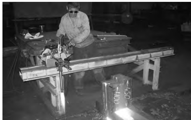
Рис. 5. Отработка режимов резки. Ступенчатый образец толщиной 400 - 450 мм после резки
