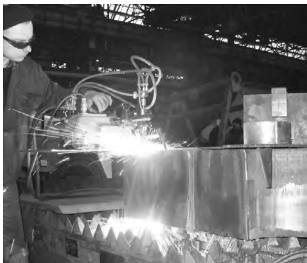
Рис. 15. Процесс вырезки полукруглых карманов на заготовке корпуса подшипника толщиной 320 мм
