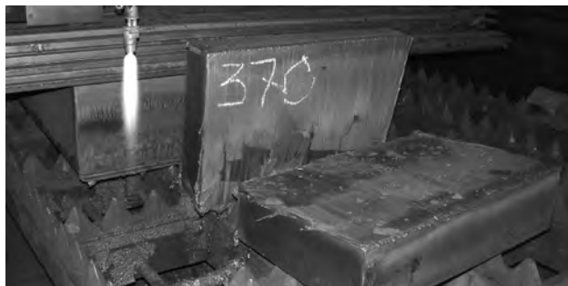
Рис. 2. Отработка режимов резки. Поверхность реза заготовки толщиной 370 мм
