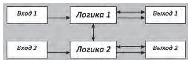
Рис. 9. Структура для категории 4 (двухканальная, с функцией самоконтроля)
