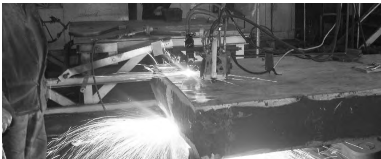
Рис. 19. Процесс вырезки отверстия на заготовке шатуна толщиной 435 мм
