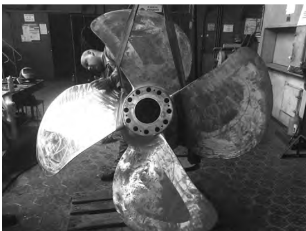
Рис. 5, в. Осмотр гребного винта после ремонта методом сварки. Капиллярный метод контроля показал отсутствие поверхностных дефектов в виде трещин и пор
