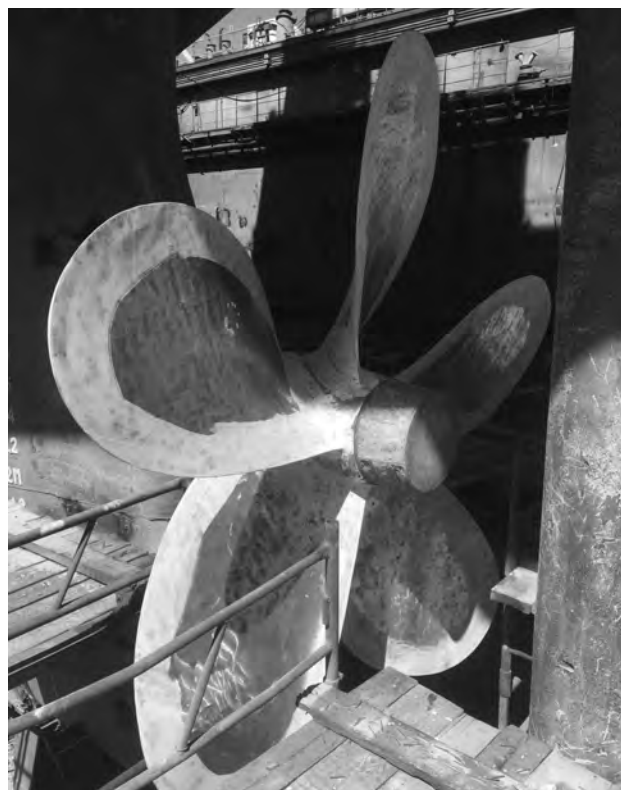
Рис. 6, а. Гребной винт после проведенной дефектации всех лопастей. На одной из кромок лопасти был выявлен дефект в виде сквозной трещины
