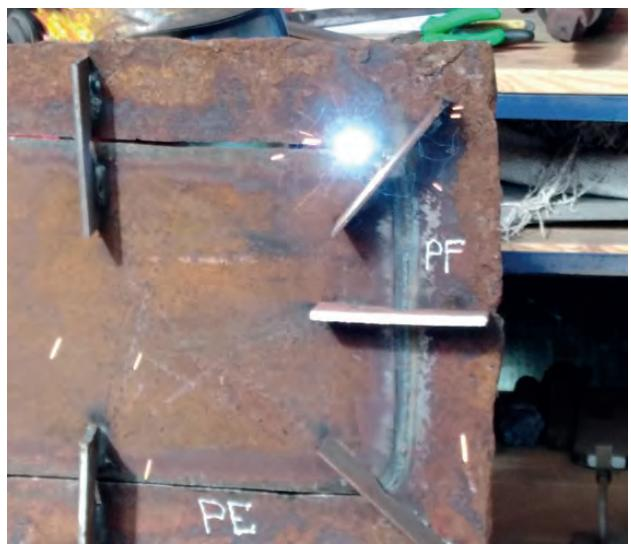
Рис. 6. Сварка корня шва в вертикальном положении (вид обратной стороны сварного шва (корня))
