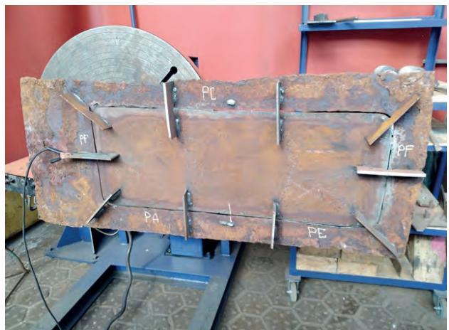
Рис. 5. Подготовленная сварная проба для сварки корневого прохода с функцией WiseRoot+. Заделка размером 450x900x8 мм вваривалась в лист, имитирующий корпус судна
