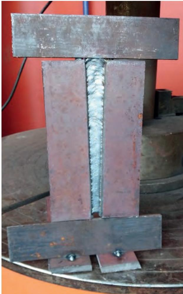
Рис. 10. Сварная проба с переменным по величине зазором
