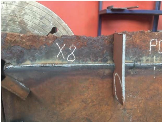
Рис. 7. Сварка корня шва в горизонтальном положении (вид обратной стороны сварного шва (корня))
