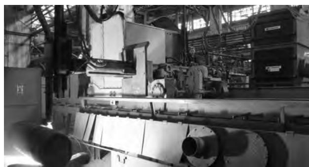
Рис. 7. Резка горячей поковки на мерные длины
