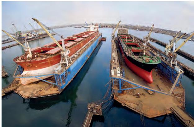
Рис. 3. Судоремонтный завод ЧАО «ИСРЗ»: вид на плавучие доки, предназначенные для проведения осмотра, покраски подводной части и ремонтно-профилактических работ корпуса судна. Доки имеют возможность постановки судна длиной 225 м, шириной 36,6 м и массой 20 тыс. т.
