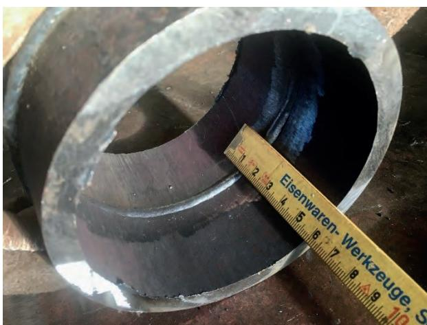
Рис. 9. Вид корня сварного шва изнутри трубы, выполненного с помощью функции WiseRoot +
