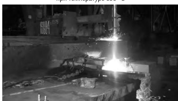
Рис. 9. Вырезка кармана на заготовке «вилка» толщиной
