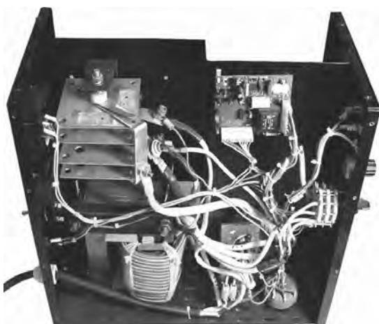
Рис. 4. Установка для механизированной сварки ПДГУ-125
