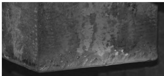
Рис. 15. Кромки реза, выполненного на УНРС. Сечение слитка 400x400 мм, температура при резке 800°
