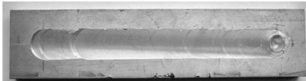
Рис. 2.1. Внешний вид образца сплава 6082 после сварки на воздухе
