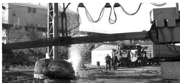
Рис. 11. Кислородная резка скрапины толщиной 1100 мм
