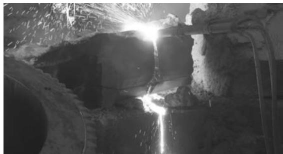
Рис. 16. Процесс резки поковки на габаритные куски. Резка горизонтальным резаком снизу – верх. Окончание резки
