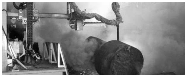
Рис. 22. Процесс резки шейки прокатного валка вертикальным резаком при движении его к машине
