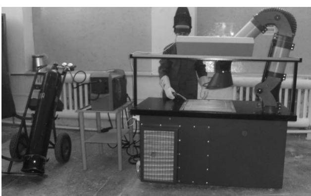
Універсальний стіл зварника з пристроєм очистки від зварювального аерозолю із зони зварювання при проведенні зварювальних робіт на столі
