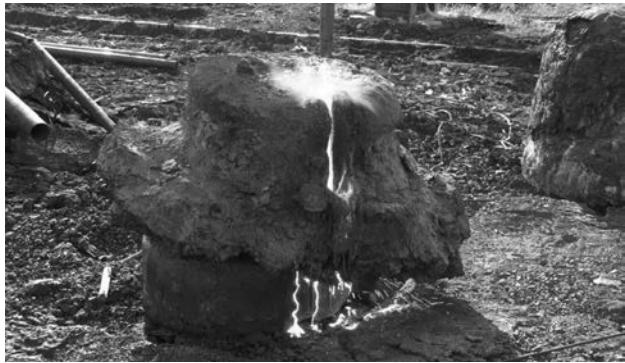
Рис. 12. Кислородная резка скрапины толщиной 1100 мм.
