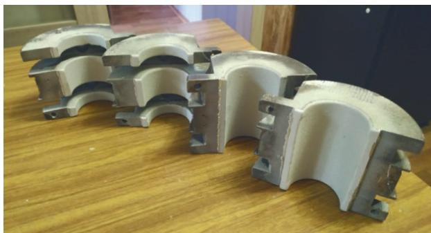
Рис. 3. Восстановленные подшипники двигателя питательного насоса ПЭ-100-53 на ТЭЦ-1
