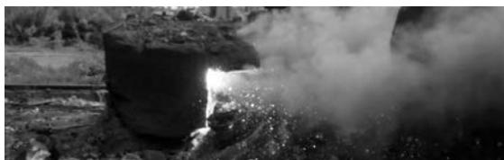
Рис. 21. Кислородная резка чугунного «козла» диаметром 2400 мм в полевых условиях с помощью переносной машины УОПП-1
