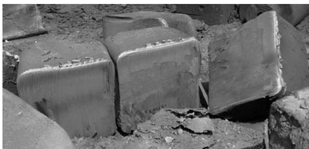
Рис. 15. Резка передельных слитков. Поверхность реза
