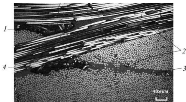
Рис. 4. Микроструктура образца углепластика [10]:
