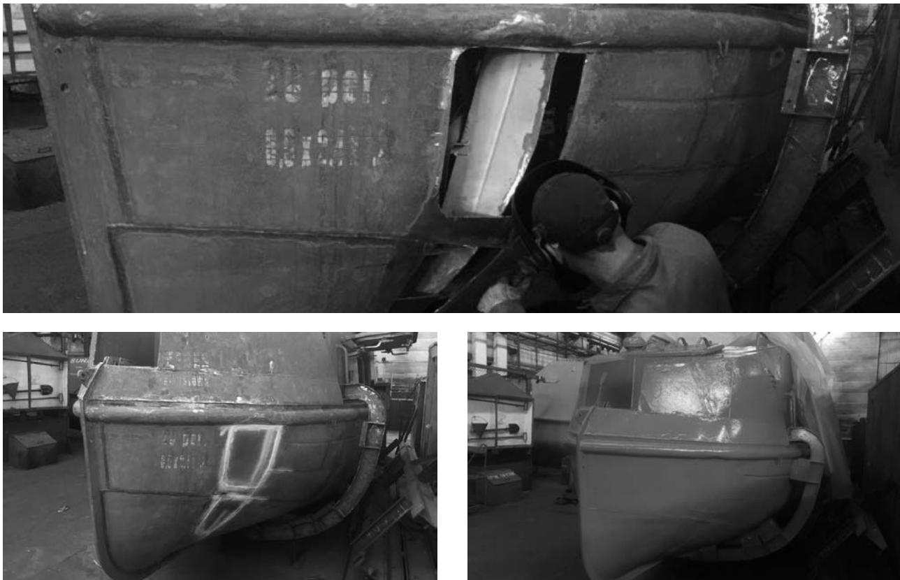
Рис. 2. Полуавтоматическая сварка плавящимся электродом в среде аргона (MIG 131).
