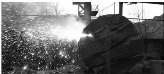
Рис. 20. Кислородная резка чугунного «козла» диаметром 1500 мм и длиной 2000 мм. Резка горизонтальным резаком слева – направо
