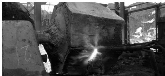
Рис. 17. Резка недоливка толщиной 1600 мм на габаритные куски.
