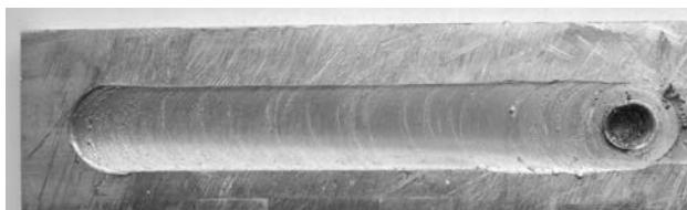
Рис. 2.2. Внешний вид образца сплава 6082 после сварки в воде
