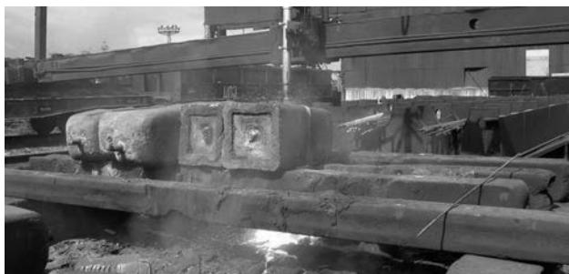
Рис. 14. Резка слитков толщиной 800 мм
