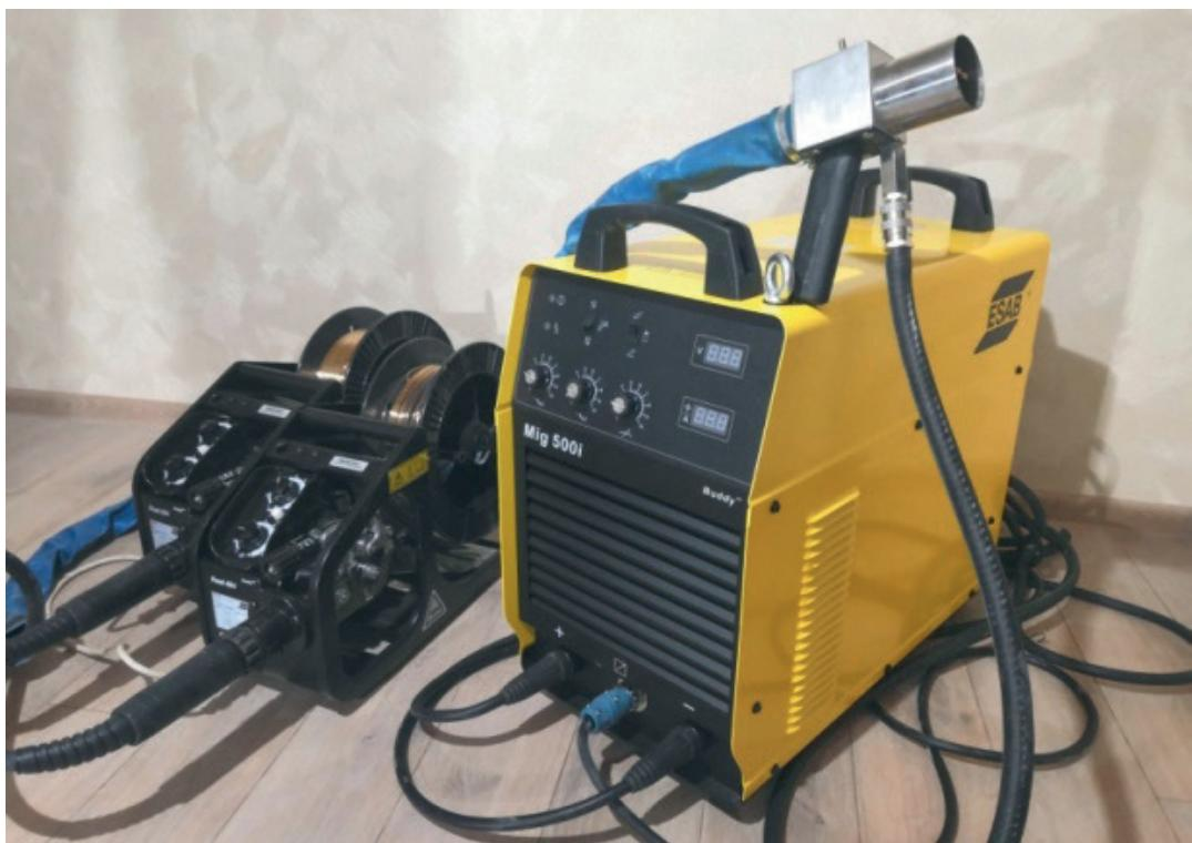
Рис. 1. Комплекс электродуговой металлизации КЭМ-1
