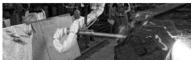
Рис. 23. Процесс резки слитка толщиной 1000 мм горизонтальным резаком при движении его сверху – вниз.
