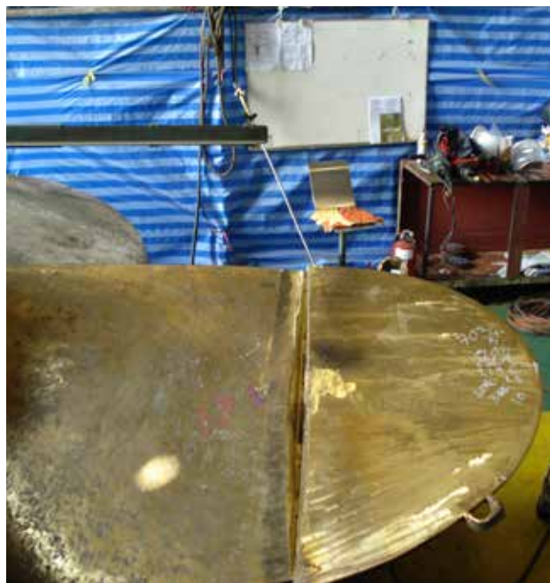
Рис. 4. Механизированная (полуавтоматическая) сварка бронзы
