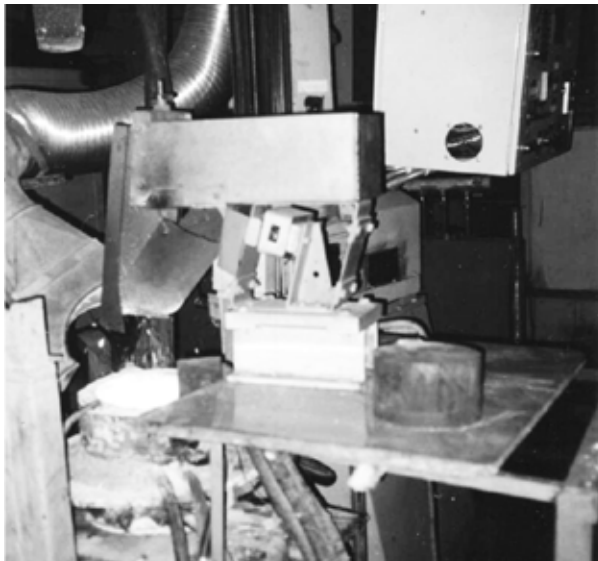
Рис. 2. Процесс электрошлаковой наплавки дискретным материалом в токоподводящем кристаллизаторе
