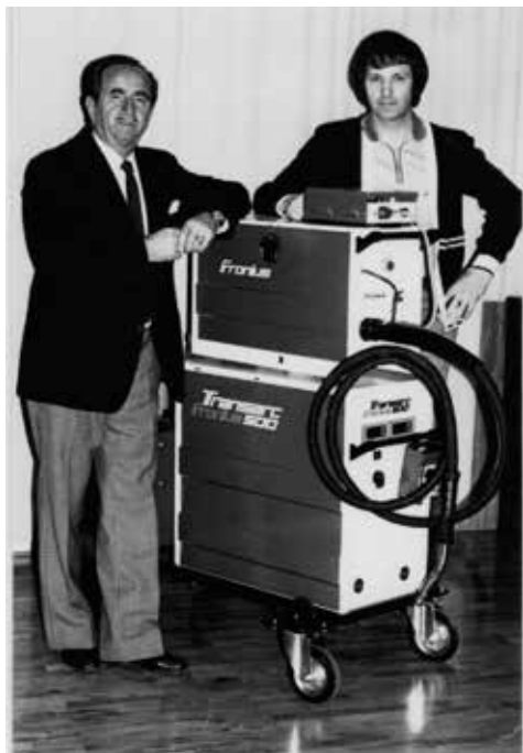
Мал. 3. Fronius Transarc 500: перша у світі зварювальна система, оснащена інвертором із транзисторним перемиканням
