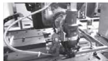
Зовнішній вигляд головки для лазерно-мікроплазменного зварювання в руці робота KUKA KR30NA
