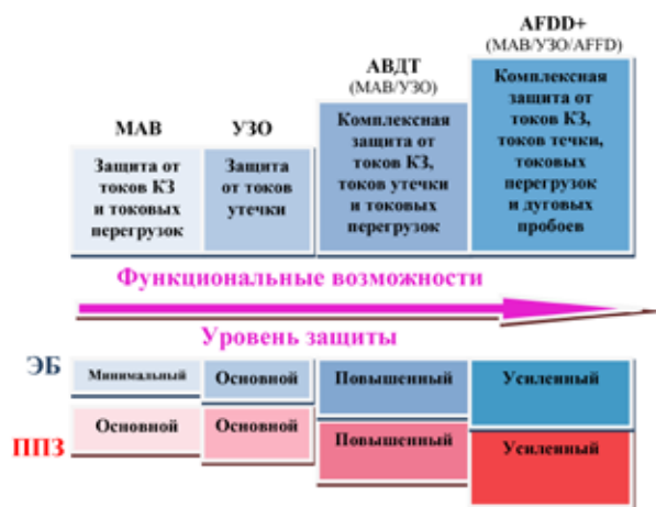
Рис. 7. Функциональные возможности и защитные свойства МАВ, УЗО, АВДТ и AFDD+
