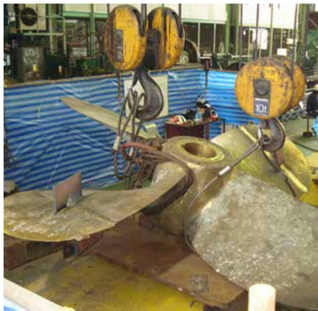
Рис. 5. Сборка под сварку лопастей гребного винта при помощи стальных сборочных гребенок
