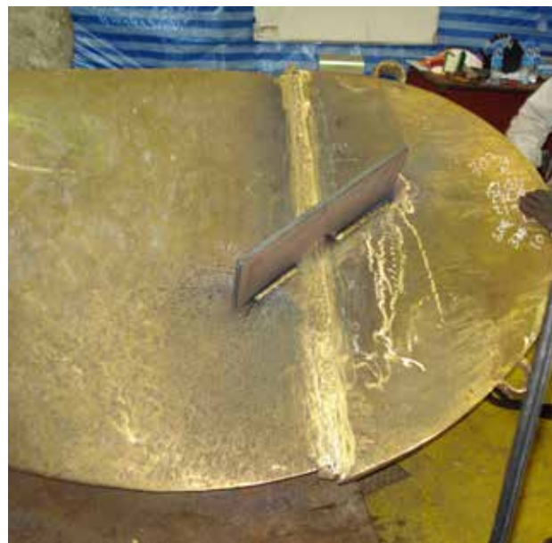
Рис. 5. Сборка под сварку лопастей гребного винта при помощи стальных сборочных гребенок
