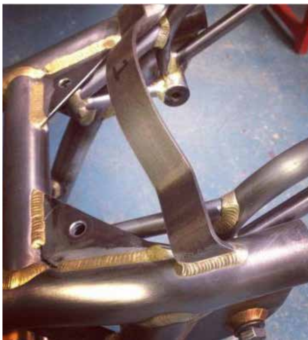
Общий вид паяных соединений, выполненных с использованием MIG-пайки
