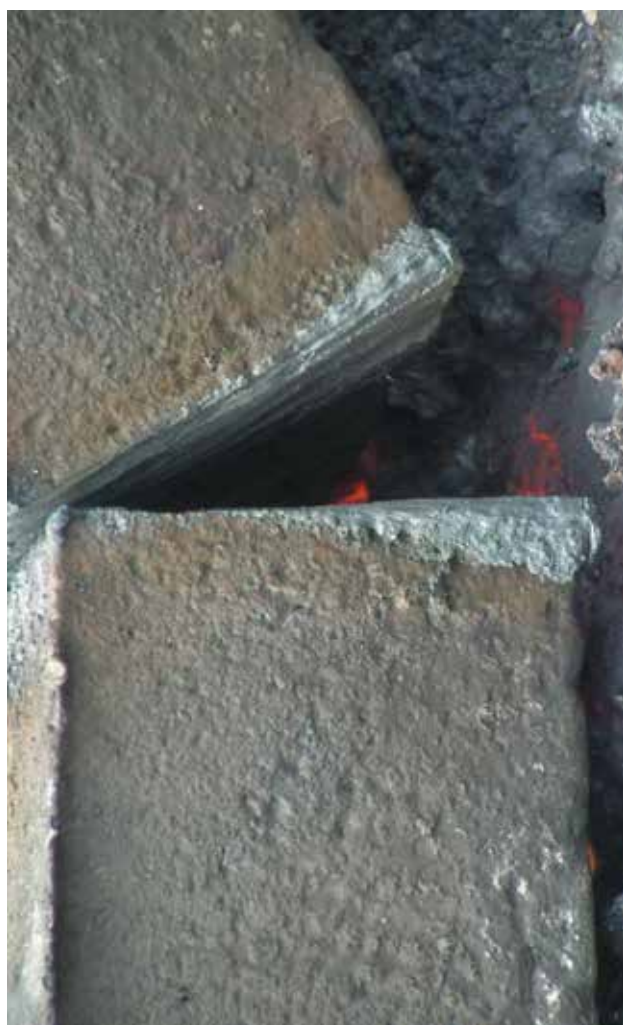
Рис. 15. НКМЗ. Разрезанная заготовка толщиной 200 мм
