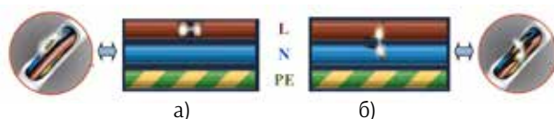
Рис. 2. Примеры дугового пробоя (замыкания) последовательного (а) и параллельного типов (б)
