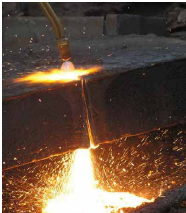
Рис. 14. НКМЗ. Процесс резки плиты толщиной 200 мм
