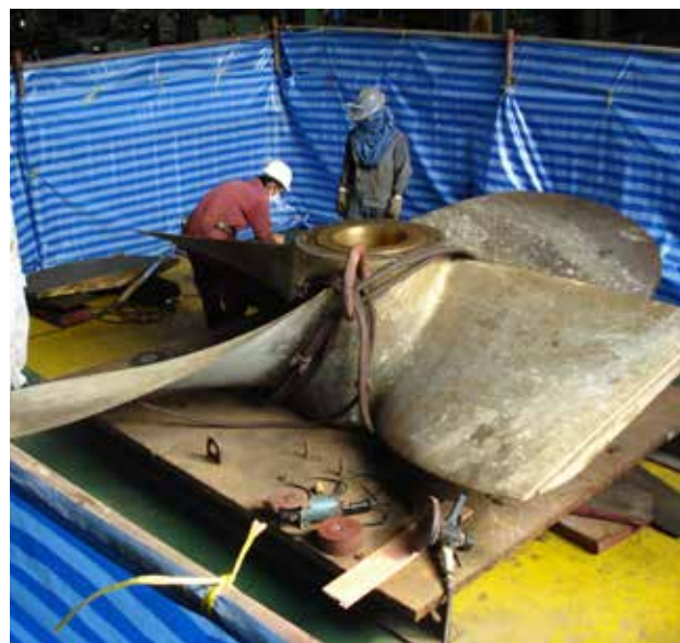
Рис. 1. Гребной винт без отрезанных (поврежденных) частей лопастей
