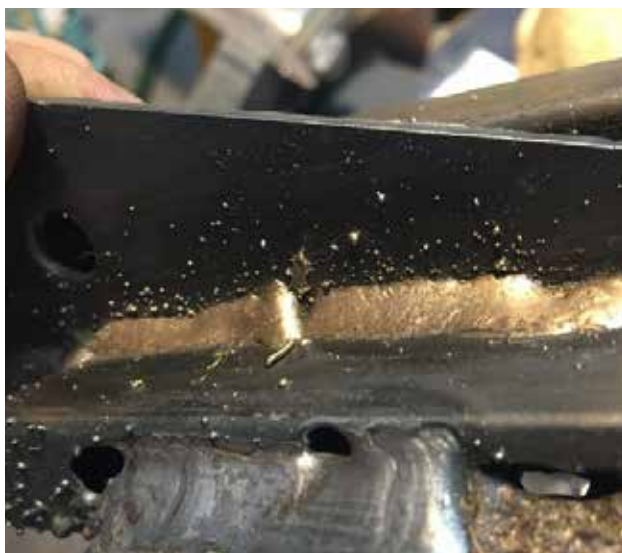
Рабочие моменты при подборе режима MIG-пайки
