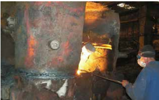
Рис. 21. Удаление пригара по линии реза прибыли толщиной 1400 мм
