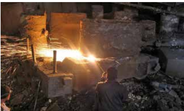
Рис. 22. НКМЗ. ФЛЦ-2. Процесс резки овальной прибыли 1200x600 мм
