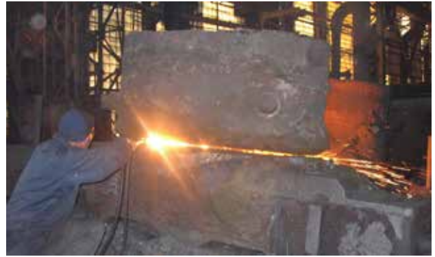
Рис. 23. НКМЗ. ФЛЦ-2. Резка прибыли 1200x600 мм и полость реза
