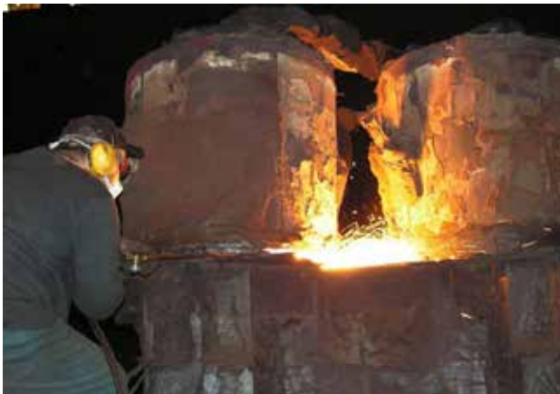
Рис. 20. НКМЗ. ФЛЦ-2. Резка прибыли литья диаметром 700 мм
