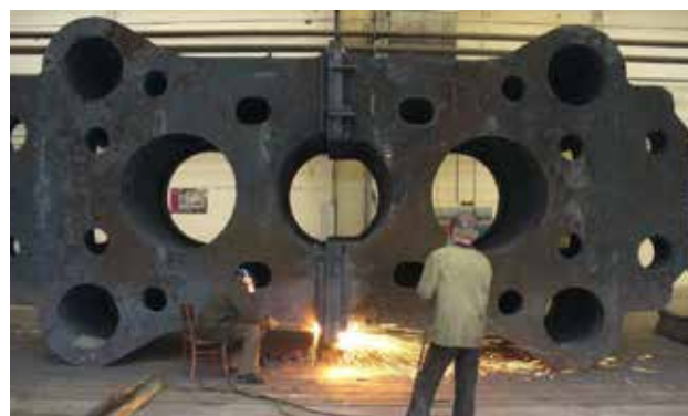
Рис. 18. НКМЗ. Термический цех. Резка выводных планок ЭШС 350 мм
