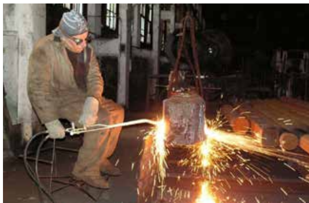
Рис. 12. Дружковский машзавод. Процесс резки блюдца толщиной 400 мм
