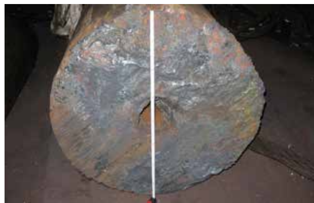
Рис. 17. НКМЗ. КПЦ-2. Поверхность реза колоны пресса
