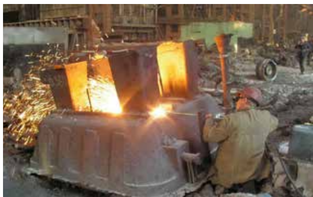
Рис. 13. Днепропетросталь. Процесс резки прибылей среднего литья
