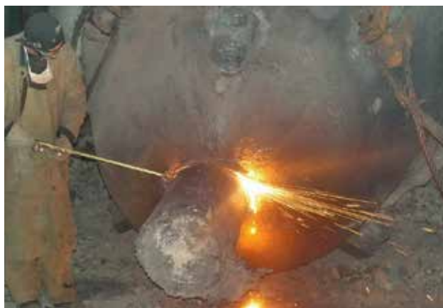
Рис. 14. Днепропетросталь. Резка прибыли чаши шлаковоза
