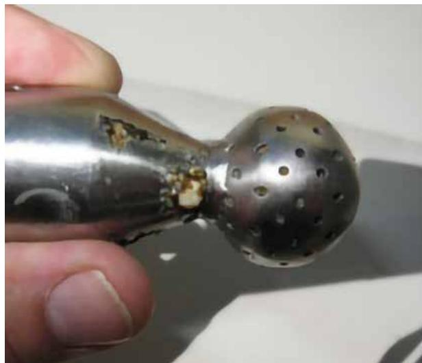
Рис. 6. Коррозия стального распылителя из молочного цеха
