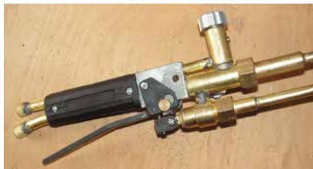
Рис. 16. Ствол резака ФЛЦ-РКФ с фиксируемым рычажным клапаном
