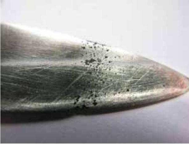
Рис. 2. Межкристаллитная (межзеренная) коррозия
