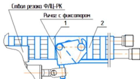
Рис. 11. Ствол с рычажным клапаном и фиксатором резака ФЛЦ-РКФ
