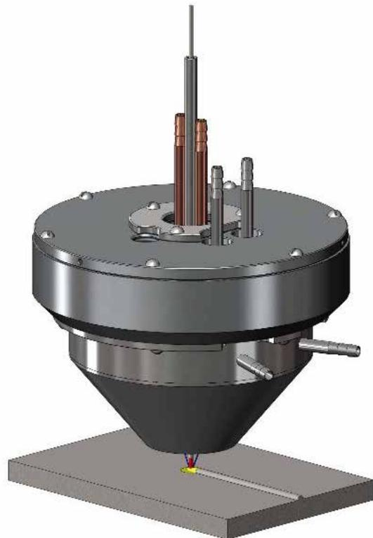
Рис. 1. Схема объединенного узла нагрева и подачи присадочного материала, используемого в xBeam 3D Metal Printer
