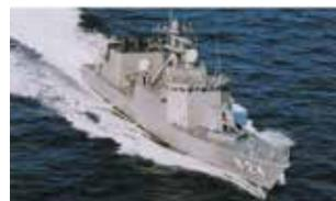
Катер з широким застосуванням алюмінієвих сплавів. Водотоннажність 200 т, довжина 50 м. Розвиває швидкість 44 вузлів
