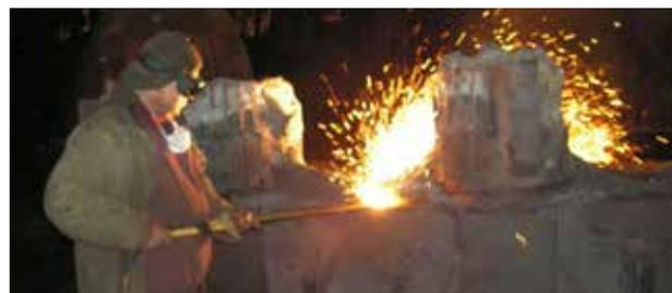
Рис. 17. НКМЗ. ФЛЦ-2. Газокислородная резка прибылей диаметром 600 мм
