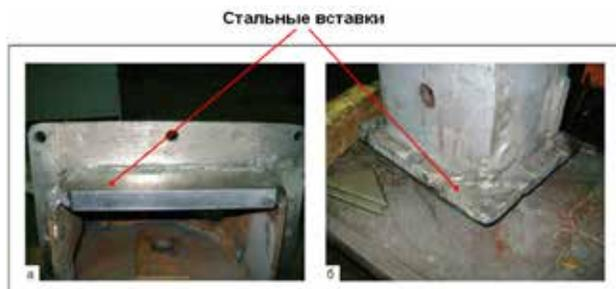
**Пример 5.** Ремонт зубчатого колеса малого привода эскалатора.
