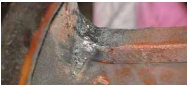
**Пример 6.** Восстановление работоспособности чугунных крышек редукторов ЦЗН-710 вагоноопрокидывателей типа ВРС.
