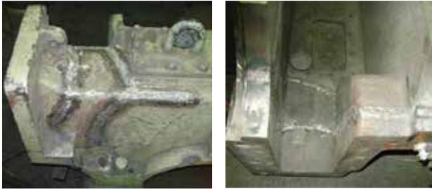
**Пример 4.** Ремонт чугунного корпуса редуктора малого привода эскалатора, используемого при экстренном или аварийном торможении.
