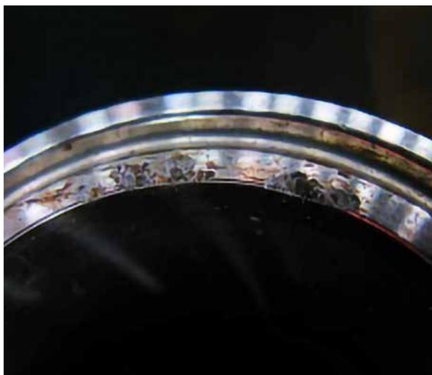
Рис. 5. Щелевая коррозия изделия из нержавеющей стали
