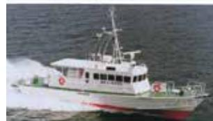
Малий риболовецький траулер. Корпус виготовлено з алюмінієвого сплаву. Загальна довжина 50 м, ширина 4,8 м, глибина 2,4 м, водотоннажність 39 т, швидкість біля берега 39,5 вузлів.
