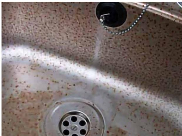
Рис. 4. Точечная коррозия раковины
