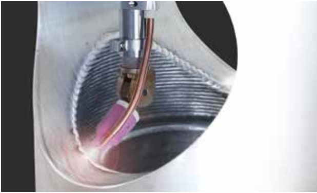
Мал 3. Процеси SpeedClad Twin або TIG із «гарячим» дротом дають змогу нанести присадочний матеріал на деталь таким чином, щоб він утворив захисний шар
