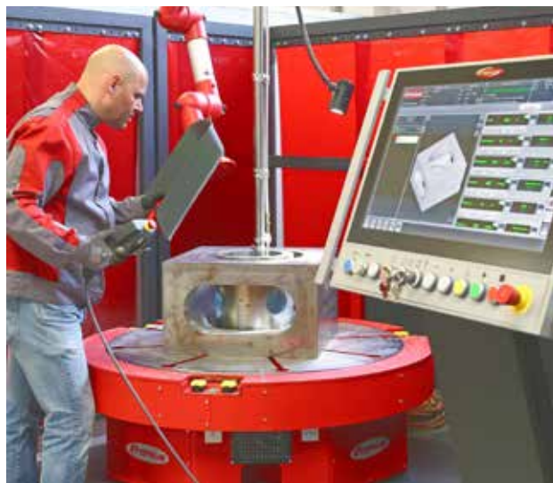
Мал. 2. Compact Cladding Cell забезпечує розміщення деталей діаметром до 1 м і висотою до 1,4 м (можливе розміщення деталей висотою до 1,9 м), що важать до 2 500 кг
