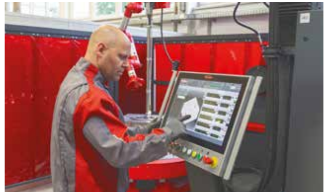
Мал 5. Елементи керування системою HMI T21 забезпечують моніторинг фактичних значень і тривимірну візуалізацію в режимі реального часу
