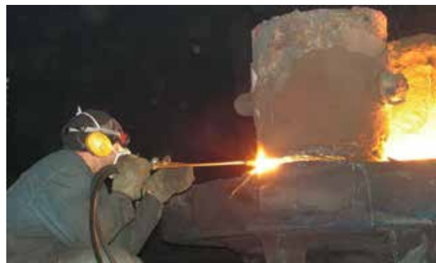
Рис. 18. НКМЗ. ФЛЦ-2. Резка прибылей крупного литья – 2
