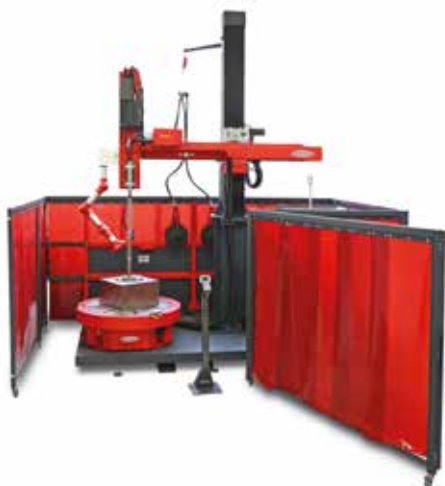
Мал. 1. Fronius Compact Cladding Cell складається з ідеально налаштованих системних компонентів: набору джерел живлення, стійки, механізму подачі дроту, поворотного столу, розподільної шафи, контролера та пульта керування
