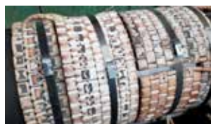
Рис. 3. Установка нагревательных элементов на шейку баллера
