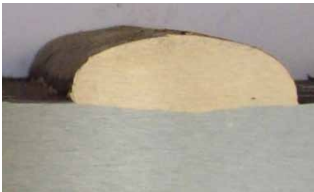
Рис. 4. Наплавка олов'яної бронзи, виконана шланговим двоелектродним апаратом (×2)
