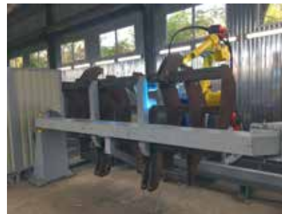
Рис. 3. Робототехнологический комплекс РК759 для МИГ-сварки крупногабаритных изделий
