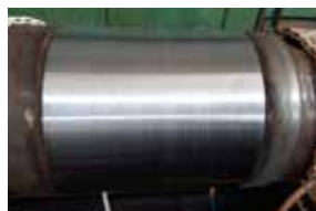
Рис. 5. Шейка баллера после механической обработки
