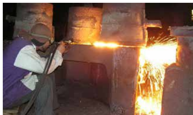
Рис. 17. НКМЗ. ФЛЦ-2. Резка прибылей крупного литья – 1
