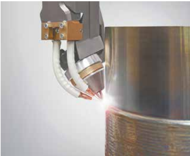
Мал 4. Процес SpeedClad Twin забезпечує втричі більшу швидкість зварювання порівняно з процесом TIG із «гарячим» дротом завдяки використанню двох електродів і двох зварювальних дротів
