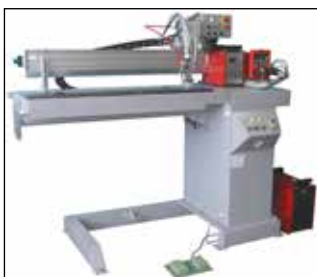
Рис. 7. Установка АС333 для ТИГ-сварки продольных швов труб
