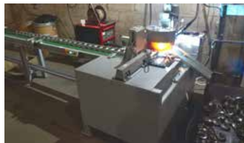
Рис. 6. Конвейер АС415 для МИГ-сварки горловины с донным корпусом огнетушителя
