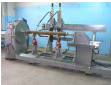
Рис. 5. Установка АС354 для наплавки тел вращения
