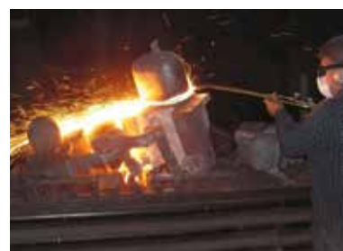
Рис. 11. НКМЗ. ФЛЦ-1. Резка прибыли толщиной 350 мм
