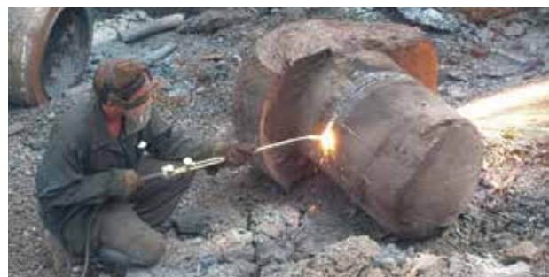
Рис. 12. НКМЗ. Копровый цех. Резка поковки толщиной 600 мм
