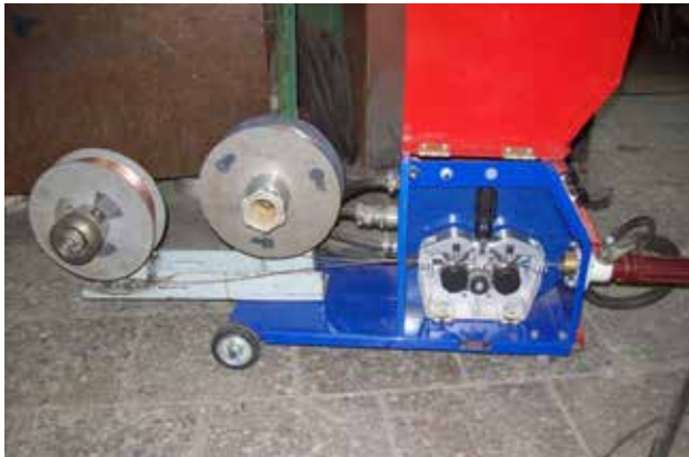
Рис. 3. Двоелектродний зварювальний апарат виконання усіх функцій, що забезпечують високоякісний процес зварювання (наплавлення).
