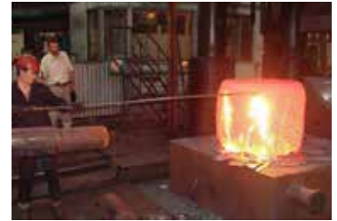
Рис. 20. Удаление поверхностных трещин на поковке перед ее прошивкой
