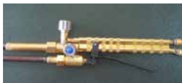
Рис. 17. Ствол резака РКВД
