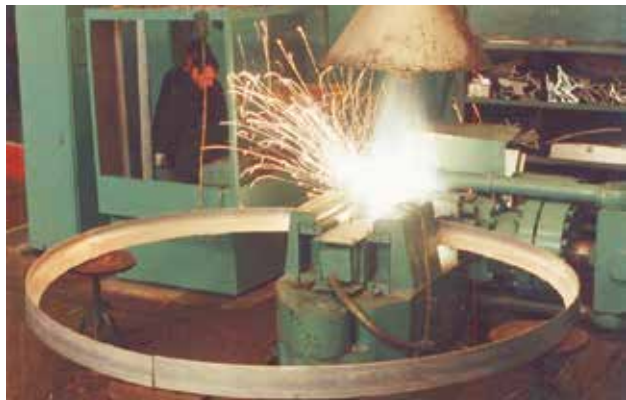
Рис. 4. Контактно - стикове зварювання оболонки паливного бака
