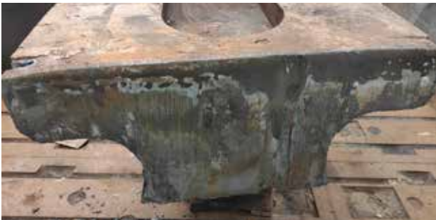
Рис. 4. Поверхность первого реза корпуса бойка
