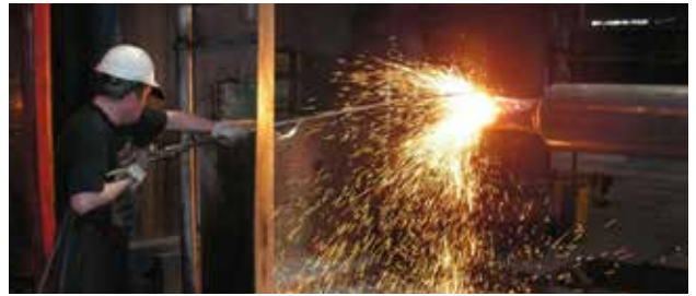
Рис. 18. Выплавка дефектов на поковке под прессом усилием 3000 тс
