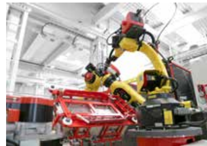
Мал. 5. Гнучкий зварювальний модуль Fronius HTW (Handling-to-Welding)
