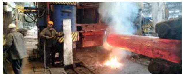
Рис. 21. Отрезка торцевой части поковки с закованной усадочной раковиной
