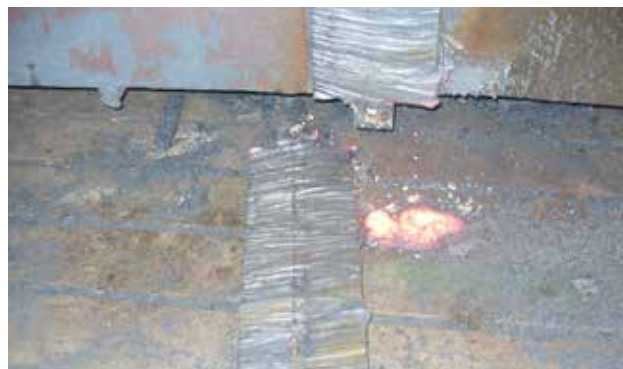
Рис. 10. Процесс кислородной резки выводных планок сварно-литого «Архитрава»
