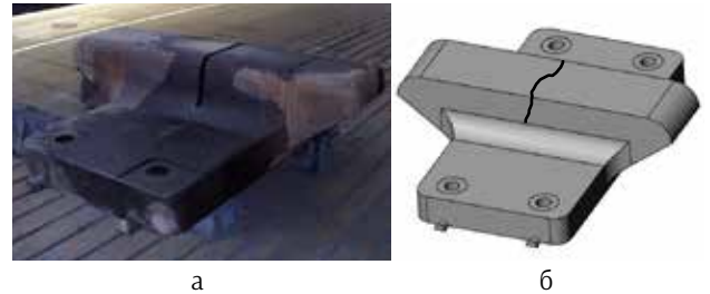
Рис. 6. Ремонт электрошлаковой сваркой выбранного механической обработкой глухого паза, полученного при удалении трещины в теле «Бойка»: а – боек с выбранной трещиной, б – трещина на рабочей поверхности бойка
