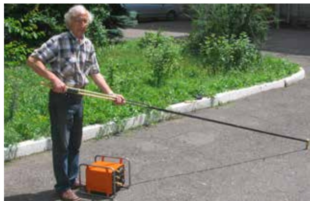
Рис. 13. Подготовка полуавтомата ПАКР к использованию при выплавке дефектов на поковках
