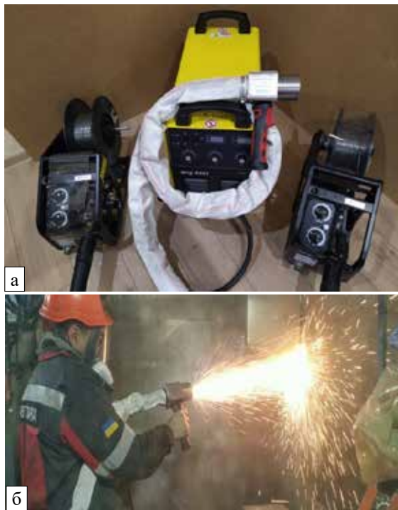
Рис. 1. Комплекс для электродуговой металлизации КЭМ-1 с металлизатором ЭМ-03 (а) и его применение для нанесения покрытий (б)
