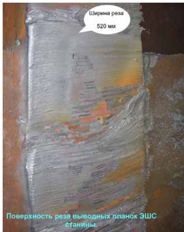
Рис. 11. Процесс кислородной резки выводных планок после ЭШС «Траверы». Суммарная толщина выводных планок и сварного шва составляет 520 мм. Справа – поверхность реза на детали
