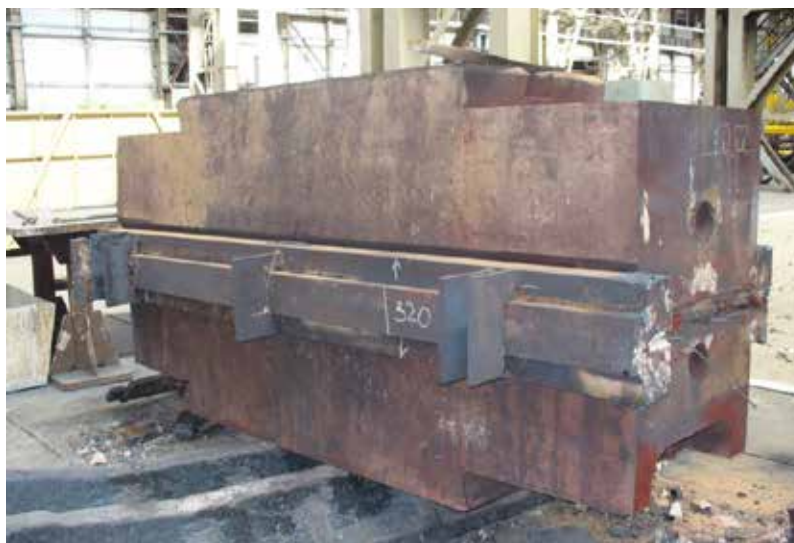
Рис. 3. Ремонт кузнечных бойков путем сварки двух изношенных заготовок: а – боек, собранный под ЭШС с установленными в разделку пластинами плавящегося мундштука; б – боек после ЭШС и высокотемпературной термической обработки
