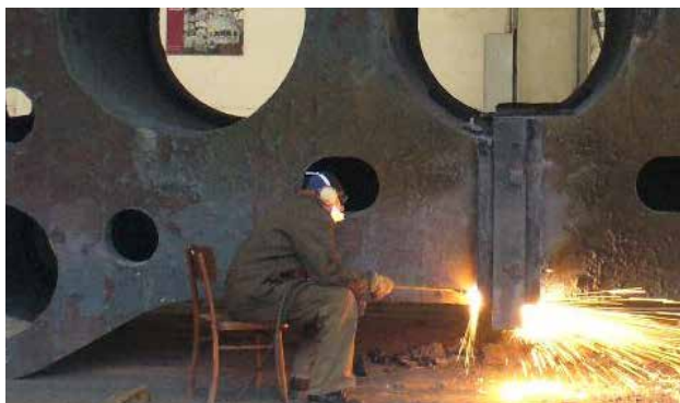
Рис. 10. Процесс кислородной резки выводных планок сварно-литого «Архитрава»
