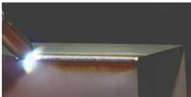
Мал. 1. Найкращі зварювальні шви при подвійній швидкості завдяки інноваційному процесу зварювання MicorTwin від компанії Lorch
