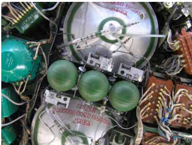
Рис. 5. Блок управління ракети 15A16
