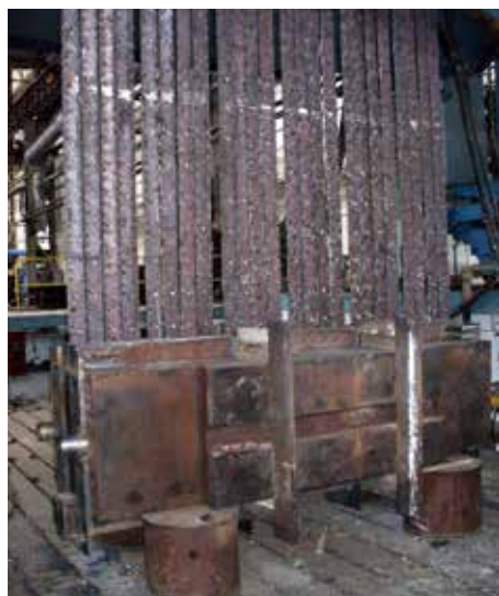
Рис. 3. Ремонт кузнечных бойков путем сварки двух изношенных заготовок: а – боек, собранный под ЭШС с установленными в разделку пластинами плавящегося мундштука; б – боек после ЭШС и высокотемпературной термической обработки
