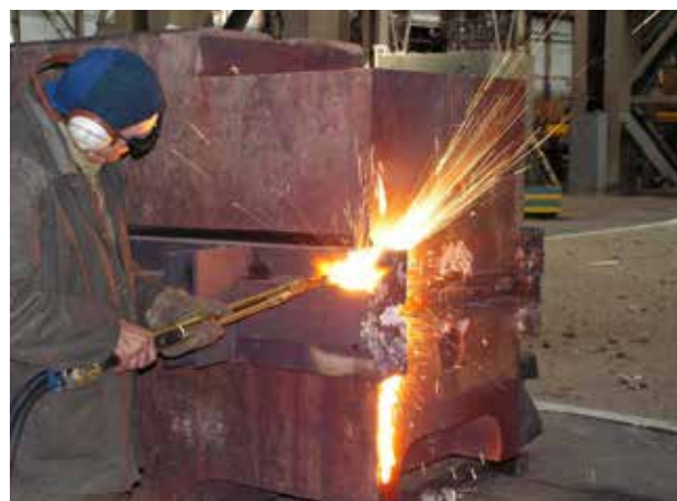
Рис. 9. Кислородная резка выводных планок при ЭШС бойка прессы усилием 10 000 тс с помощью полуавтомата ПАКР
