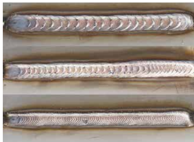
Мал. 3. Необхідний зварювальний шов завдяки натисненню кнопки: за допомогою динамічного налаштування можна індивідуально адаптувати ступінь лущення – від грубої (вище) до звичайної та дрібної (нижче)
