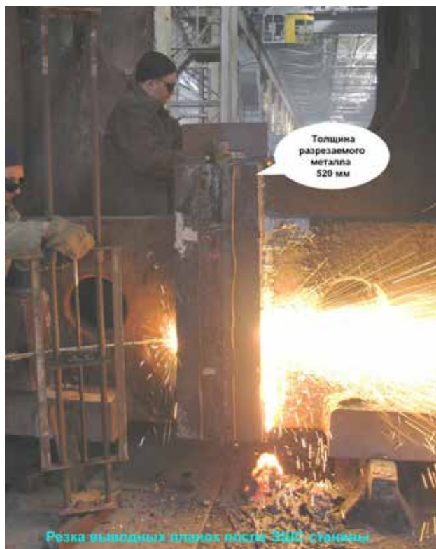
Рис. 11. Процесс кислородной резки выводных планок после ЭШС «Траверы». Суммарная толщина выводных планок и сварного шва составляет 520 мм. Справа – поверхность реза на детали
