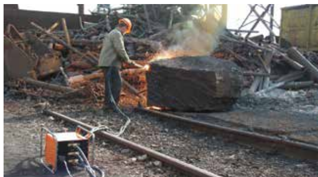
Рис. 12. Кислородная резка крупных кусков металлического лома с помощью полуавтомата ПАКР
