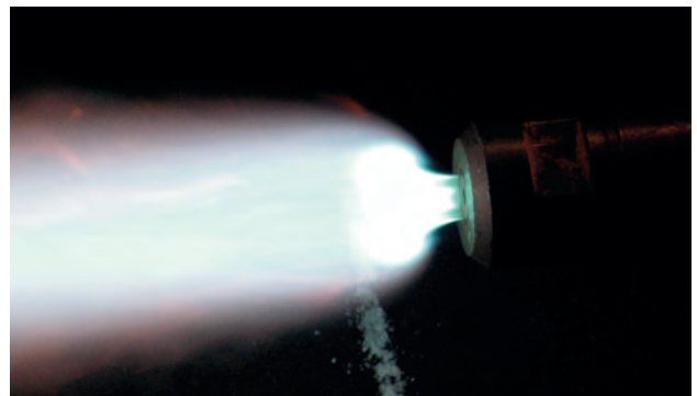
Рис. 13. Ядро факела ацетиленокислородной горелки ГА-40
