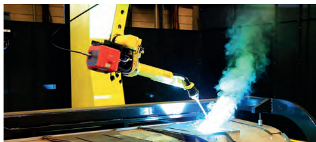
Мал. 1. TPS 600i у поєднанні зі зварювальним процесом РМС, що використовується при зварюванні ковша екскаватора
