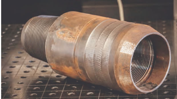
Замок для бурильної труби після плазмової строжки, готовий до зварювання
