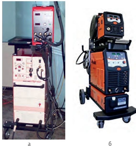
Рис. 3. Установки для зварювання алюмінієвих сплавів плавким електродом TPS 450 фірм Fronius (а) та Kemppu OY (б) требованими на виробничих майданчиках України виявилися зразки TPS 450 фірми Fronius і Kemppu OY (рис. 3).
