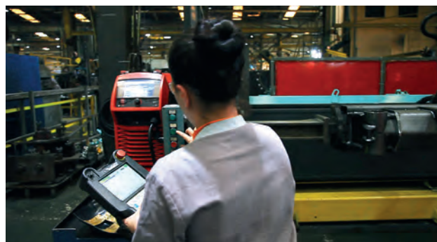
Мал. 2. Високопродуктивна зварювальна система Fronius – TPS 600i
