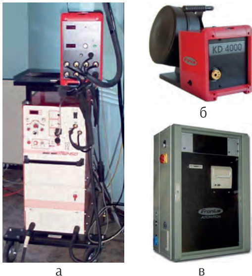
Рис. 2. Установка PT450-2 WZ Fronius (Австрія) для плазово-дугового зварювання різнополярним асиметричним струмом (а), механізм подачі присадного дроту KD 4000 (б), система керування процесом зварювання FRA 2003 (в)
