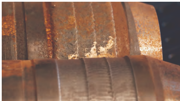
Замок для бурильної труби - до та після плазмової строжки
