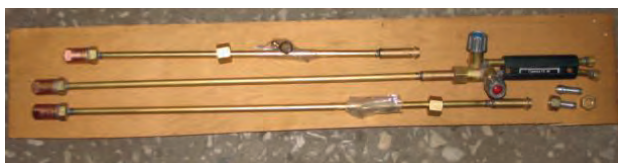
Рис. 9. Ацетиленокислородная горелка ГА-40. Наконечник № 2 (20 кВт) в сборе со стволом – в центре, наконечник № 1 (12 кВт) – вверху, наконечник № 3 (40 кВт) – внизу
