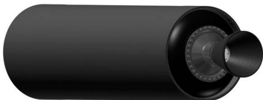
Рис. 2. Маршовий твердопаливний двигун оперативно-тактичної ракети. Зовнішній діаметр – 1000 мм, тяга 20 тс, корпус – вуглепластик типу «кокон», сопло – титан
