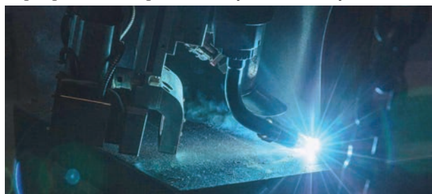
Мал. 1. Процес лазерно-гібридного зварювання зі зварювальною головкою LaserHybrid Twin
