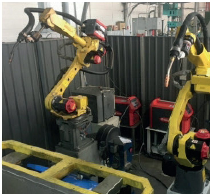
Рис. 3. Робототехнологический комплекс РК754 с одним (а) и с двумя (б) роботами
