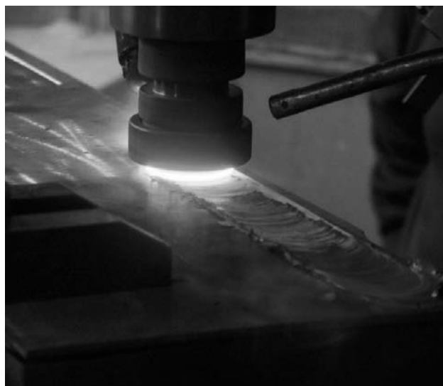
Мал. 2. Процес зварювання міді тертям з перемішуванням на фрезерному верстаті з використанням інструменту ВК 10КС
