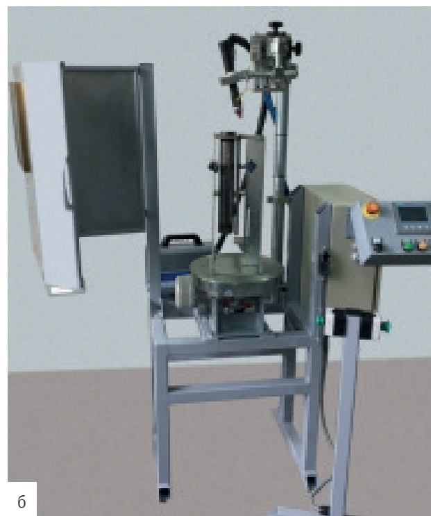
Рис. 1. Внешний вид установок АС420 (а) и АС421 (б) и свариваемых на них деталей корпуса нагревателя бойлера
