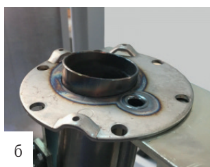
Рис. 1. Внешний вид установок АС420 (а) и АС421 (б) и свариваемых на них деталей корпуса нагревателя бойлера
